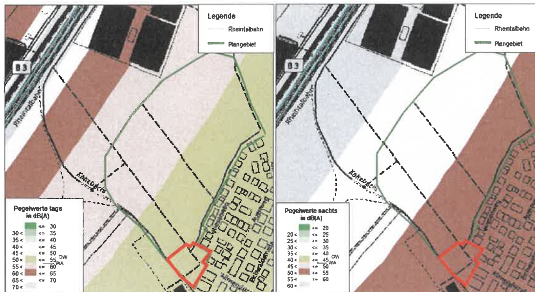
Abbildung 3: Lärmkarte Schiene tags und nachts; Auszug aus den Schalltechnischen Untersuchungen (Stellungnahme) zum Baugebiet "Waldfeld III" in Sasbach; Büro Heine und Jud; Stand: 21.02.2019
